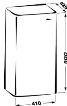
Габаритные размеры бойлера косвенного нагрева B60Z
