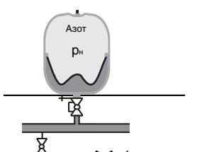
**Медленно открыть запорную арматуру**, через кран для слива удалить воздух из расширительной линии, после чего кран для слива закрыть.
