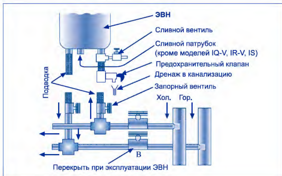
Рис 1. Схема подключения ЭВН к водопроводу
