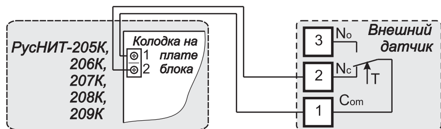
Рис. 9. Схема подключения выносного датчика температуры.
