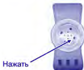
Рис.3. Расположение штока на термовыключателе термостата
