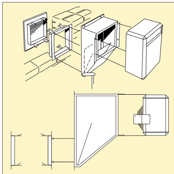
Рисунок 2: Общий вид Panther с камерой смешения.
