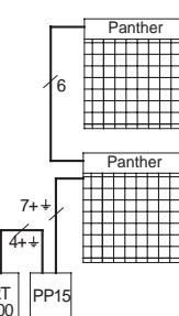
**2-х ступ. управление скоростью вентилятора и мощностью в режимах 0-1/2-1/1 с пульта PP20 и внешнего термостата. Подключение ведомых аппаратов. Подключение таймера.**
