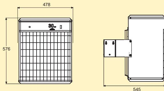
**Камера смешения, PBS01/02**
