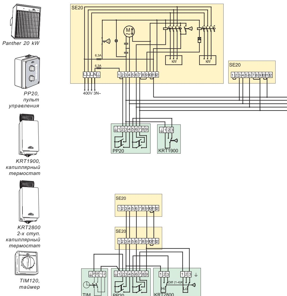
**2-х ступ. управление скоростью вентилятора и мощностью в режимах 0-1/3-2/3-1/1 с пульта PP30 и внешнего термостата. Подключение ведомых аппаратов. Подключение таймера.**
