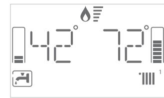
**Регулирование температуры воды в контуре ГВС**
