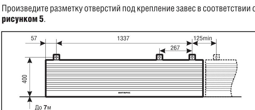
Крепление завесы к горизонтальному кронштейну осуществляется с помощью штатных кронштейнов крепления, входящих в комплект поставки.
