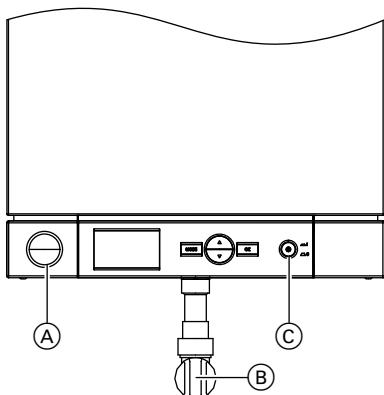
1. Проверить давление отопительной установки по манометру **(A)**.
