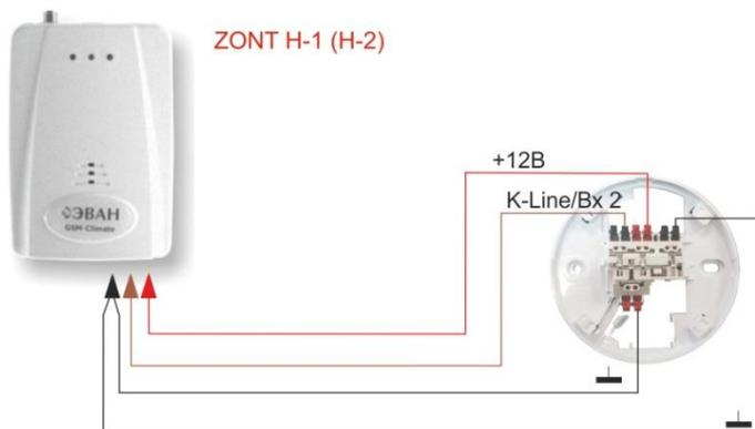
**ВНИМАНИЕ!** Провода «земли» должны иметь соединение друг с другом только в точке соединения с оборудованием ZONT
