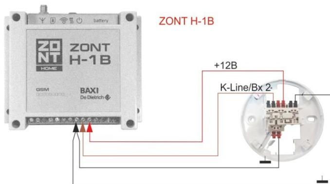
**ВНИМАНИЕ!** Провода «земли» должны иметь соединение друг с другом только в точке соединения с оборудованием ZONT
