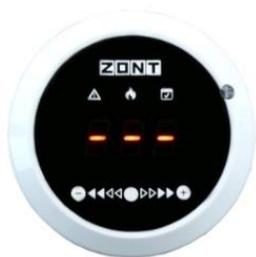
Не подключен (не назначен) датчик температуры
