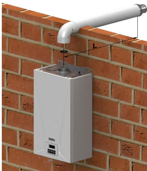
Рис. 5 Схема присоединения коаксиального дымохода Ø 100 / Ø 60 (мм) к котлу и установка диафрагмы
