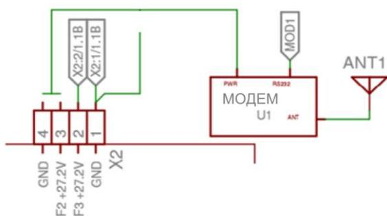
Рисунок 29 Подсоединение модема
