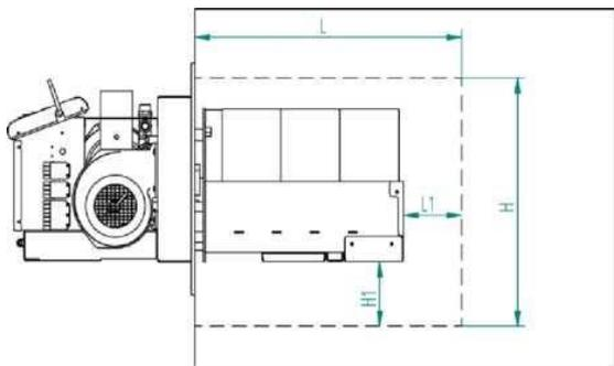
Глубина топки котла должна быть не менее чем в 2,5 раза длиннее, чем длина камеры сгорания горелки. Поэтому минимальная длина топки L для PV700 должна быть 1500 мм, а для PV1000 1800 мм. Высота топки должна оставлять минимум 100 мм для золы ниже камеры сгорания (H1) под камерой сгорания. Минимальные размеры: L1 > 700 мм; H > 650 мм. См. рисунок 5.
