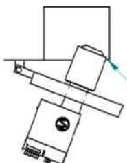
**Рисунок 6. Горелка должна выходить из котла**
