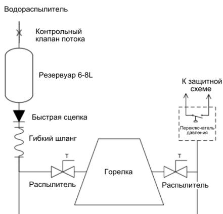
Рисунок 25 Установка водораспылителя
