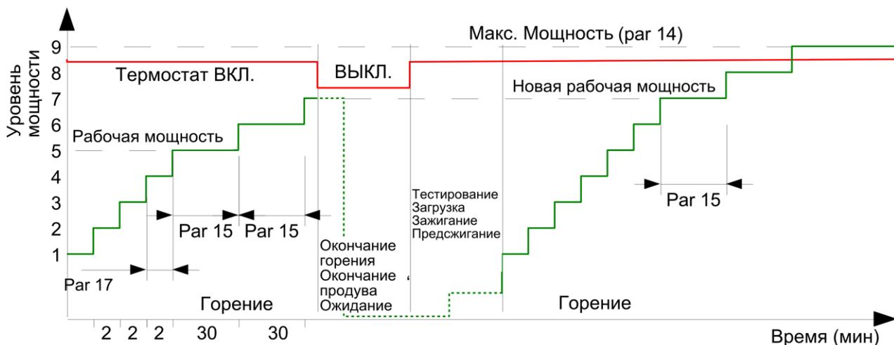
Рисунок 34. Процедура сжигания при выборе мощности = AUTO
