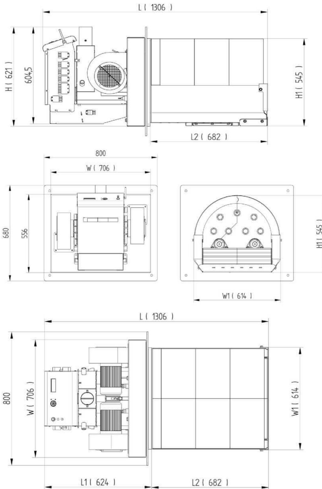
Рисунок 1 Основные параметры горелки PV1000
