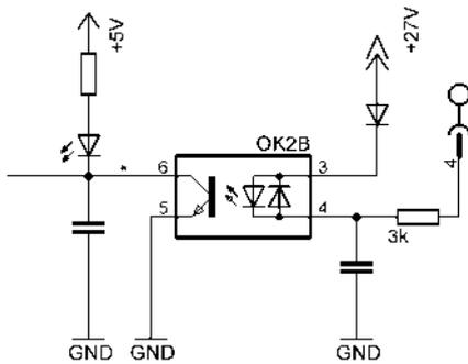
Рисунок 43. Входной контур постоянного тока
