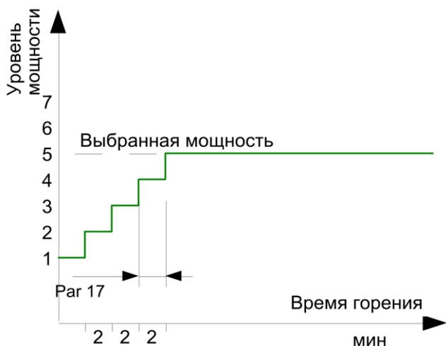
Уровень мощности можно выбрать в основном меню. Выбор мощности для времени сжигания может быть автоматическим или фиксированным на одном из основных уровней. При фиксированном уровне мощности, мощность постепенно повышается до выбранного уровня и будет удерживаться пока термостат котла не выключится.
