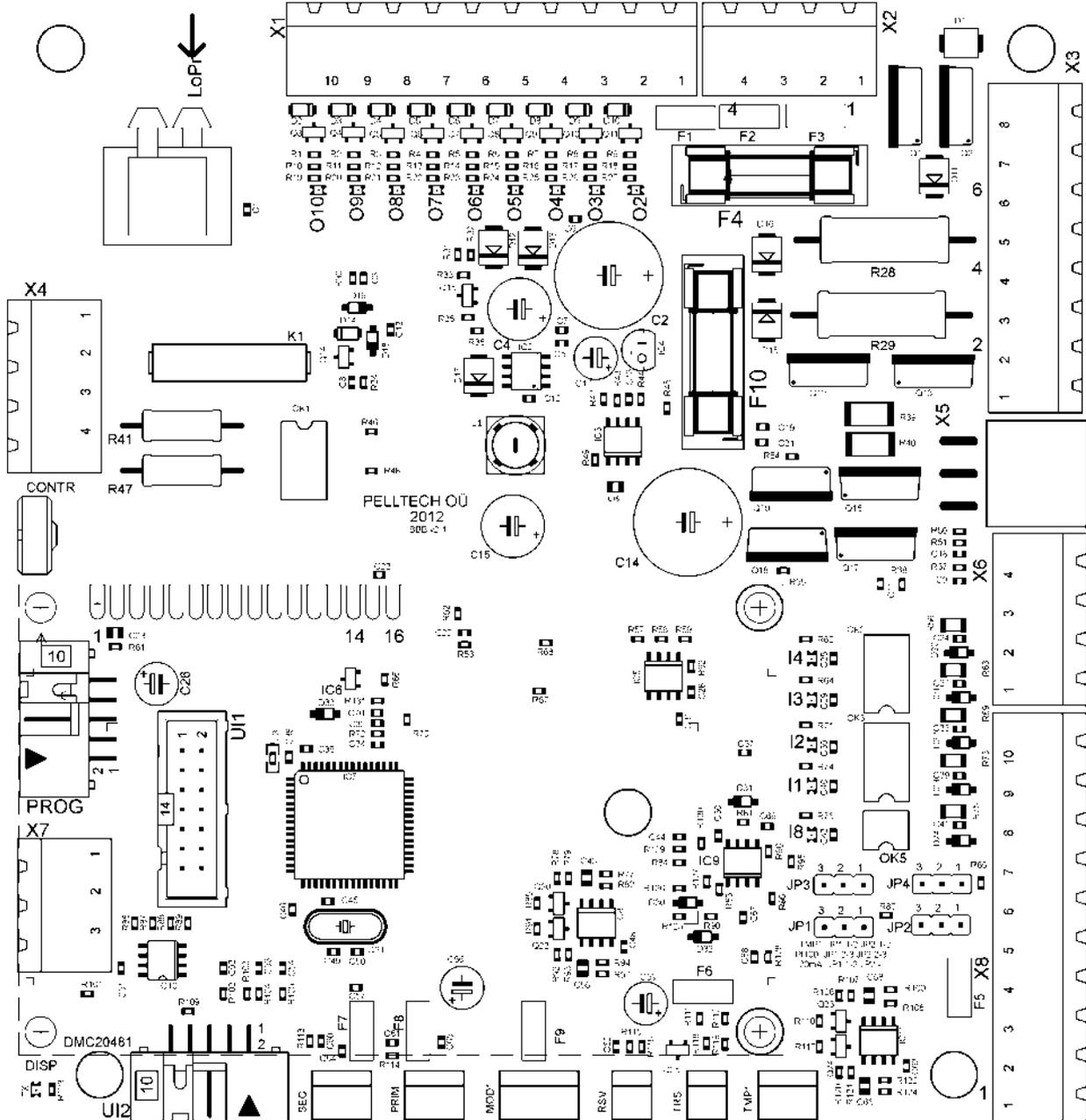
Предохранитель F4=6A 24 В постоянного тока Подача электропитания
