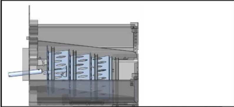
Соедините линейный двигатель с держателем движущейся решетки. Используйте трубку 27x2,5 мм (длиной 240 мм), болт М8х45 для стенки камеры сгорания и разъем болт М6х25 и для насадки (DIN914 45Н) на продольной стенке двигателя.
