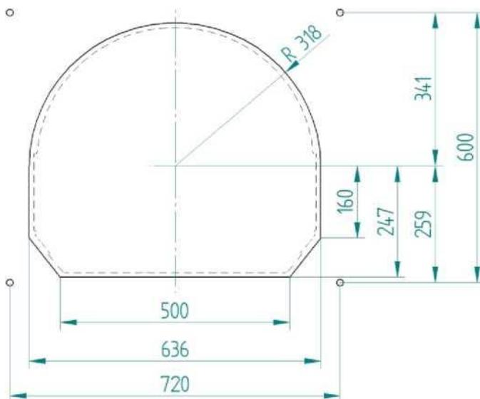
Рисунок 4 Контур резания
