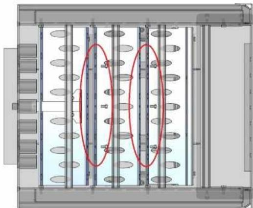
Подсоедините движущиеся решетки с помощью болтов М6х12 мм.
