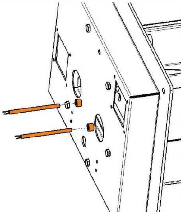
4) Штыри ТЭНов-запальников должны быть установлены в соответствующие отверстия. Обеспечьте, чтобы штыри ТЭНов-запальников не касались металлических частей внутри камеры сгорания. Зафиксируйте ТЭНы-запальники с помощью винтов.
