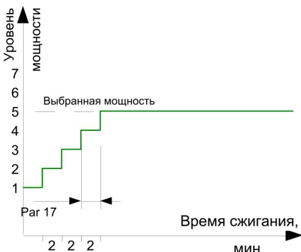
Уровень мощности можно выбрать в основном меню. Выбор мощности для времени сжигания может быть автоматическим или фиксированным на одном из основных уровней. При фиксированном уровне мощности, мощность постепенно повышается до выбранного уровня и будет поддерживаться пока термостат котла не выключится.
