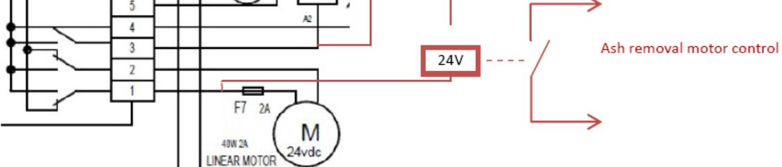
Горелка может управлять внешним мотором удаления золы с помощью соединения к мотору решетки. 24В НР (нормально разомкнутое) реле должно быть подсоединенено параллельно мотору решетки. В ходе цикла очистки, реле питается и включается внешний мотор очистки котла от золы.
