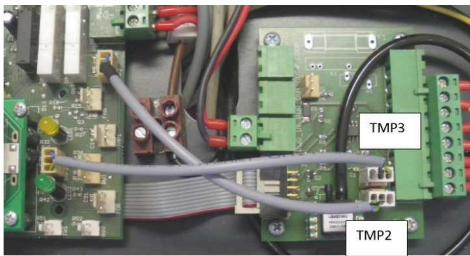
Рисунок 6. Подсоединение платы расширения
