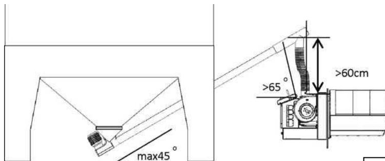
Рис. 4 Соединение внешнего шнека
