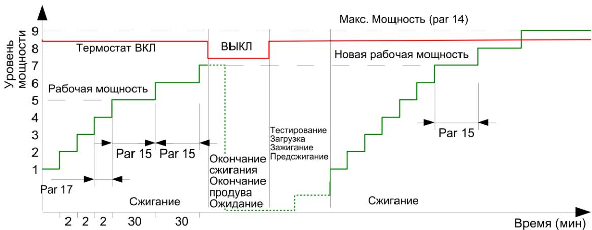
Рисунок 12. Процесс сжигания при выборе мощности = АВТО
