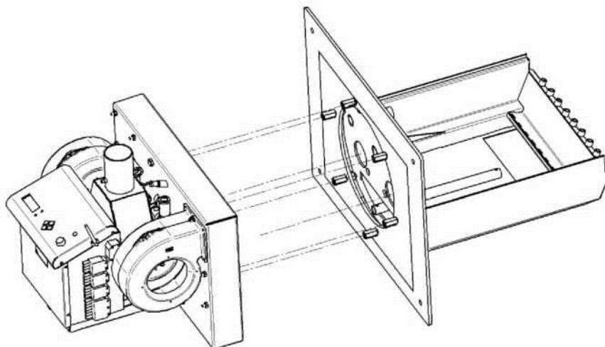
3) Установите заднюю часть, используя болты M12x70 и шайбы к соединительным гайкам камеры сгорания. Керамический уплотнитель следует поместить между горелкой для пеллет и дверцей котла (или фланцем). Труба подачи должна проходить через отверстие на задней стенке камеры сгорания.
