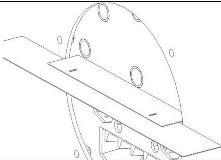
Воздушный сепаратор разделяет потоки воздуха от основного и вспомогательного вентиляторов к камере сгорания. Воздушный сепаратор должен быть подогнан к стенке камеры сгорания, где не должно быть зазора между воздушным сепаратором и стенкой камеры сгорания.
