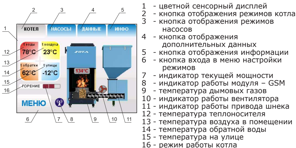
Рис.4 Расположение органов управления и индикации на передней панели пульта управления
