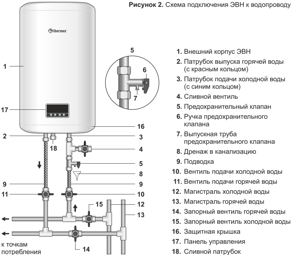
Рисунок 2. Схема подключения ЭВН к водопроводу
