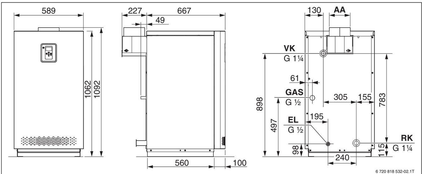
Рис. 4 Размеры и подключения 50 кВт (в мм)
