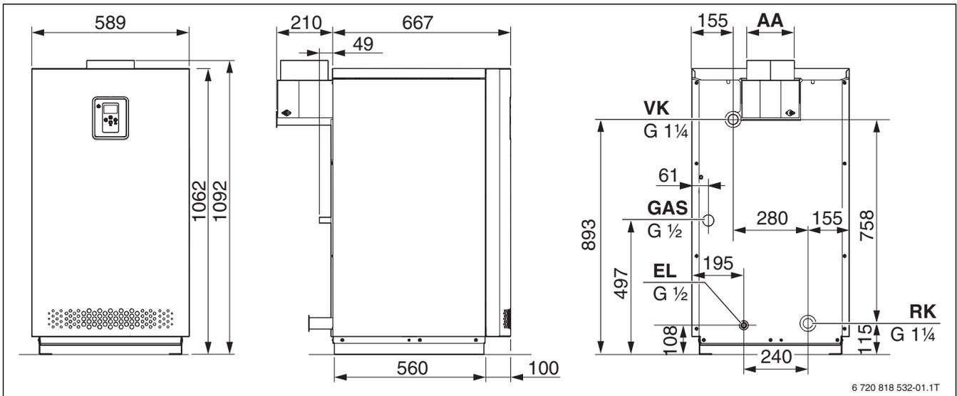
Рис. 3 Размеры и подключения 30/40 кВт (в мм)
