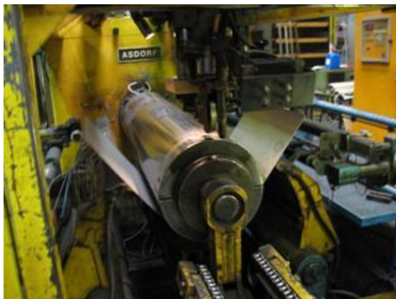
Прокат и сварка стенок бака из стального листа
