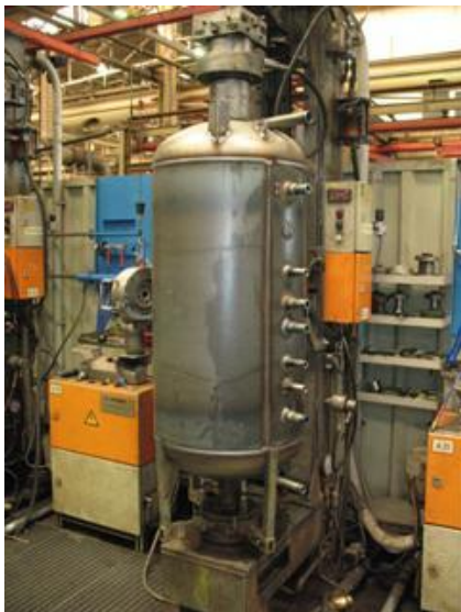
Проверка бака на герметичность
