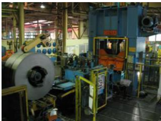
Производство верхней и нижней части бака
