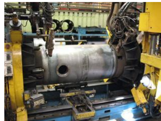
Сварка основных составных частей бака
