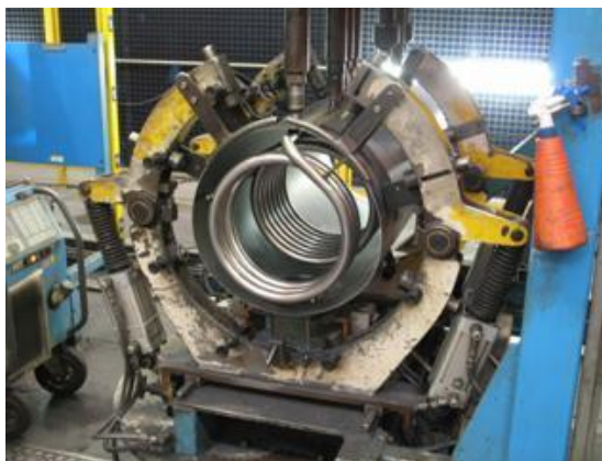
Соединение теплообменника со стенками бака
