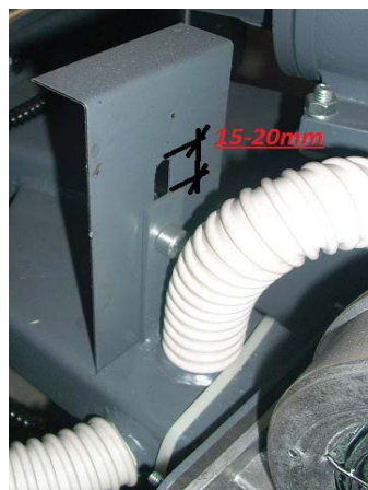
Положение направляющей воздушной заслонки системы безопасности
