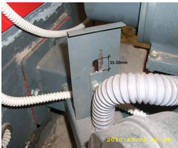
Рисунок 7. Положение клапана вентилятора
