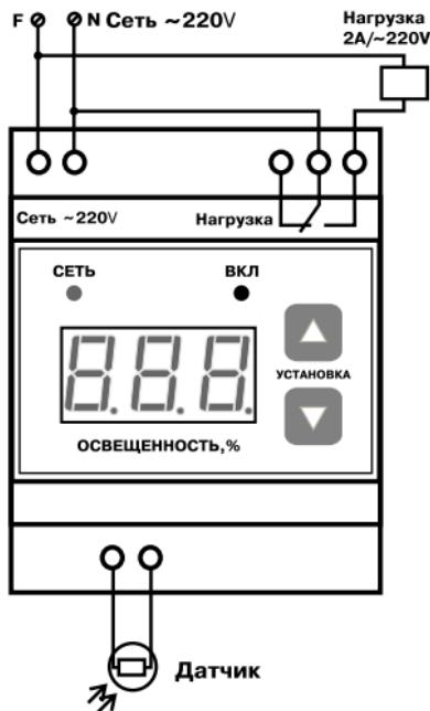
**Рис.2 Схема подключения фотореле**
