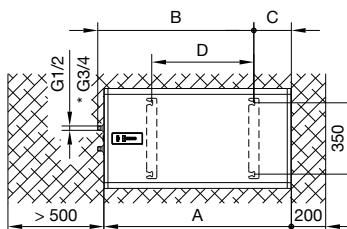
**Рис. 2:** Монтаж на стену в горизонтальном положении
