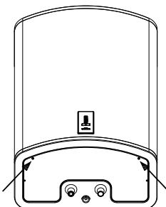
Рис. 5: Снятие предохранительной крышки
