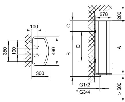
**Рис. 1:** Монтаж на стену в вертикальном положении
