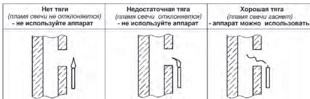
Рис. 4. Способ проверки тяги в дымоходе
