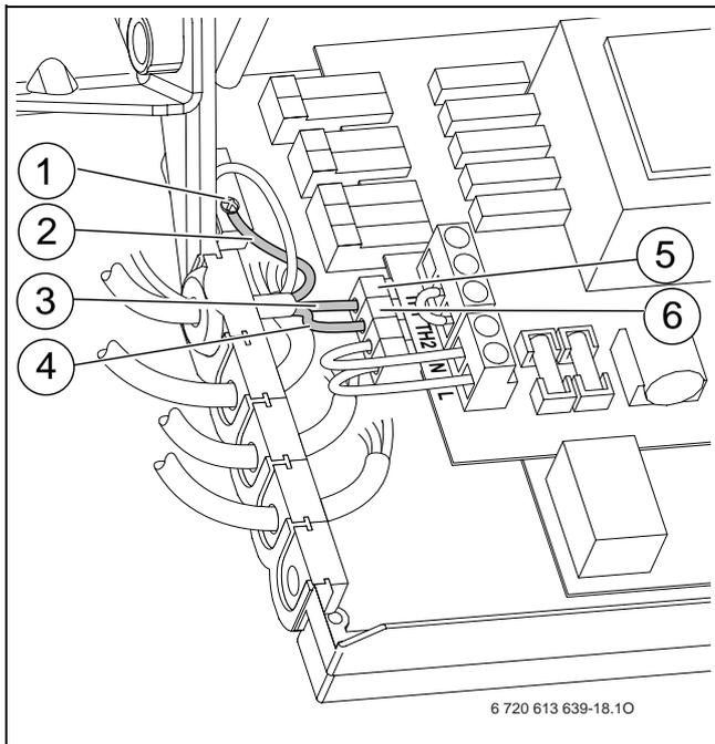
Рис 18 Подключение сетевого кабеля 230 В перем. тока
