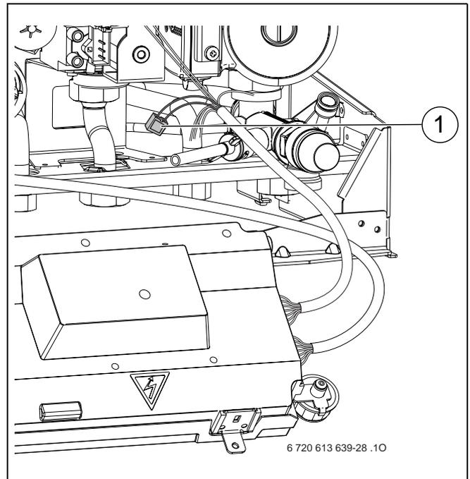
Рис 19 Разъем для подключения датчика температуры бойлера (NTC)
