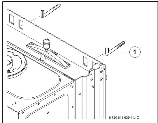
Рис 12 Подвешивание прибора
