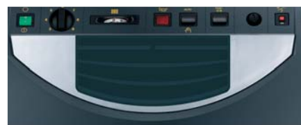
Рациональная панель EASYMATIC с диалоговым модулем (погодозависимое управление прямым контуром отопления и контуром ГВС).
